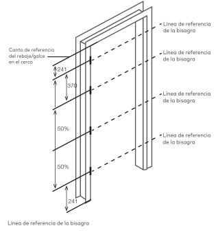
**Ámbito de aplicaciones:** Para puertas sólidas de paso. Utilice la marca M∂P⊕ RH de 36mm.
