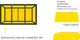
Estructura interna o bastidor del casetón, fabricado a partir de madera sólida o ángulo metálico
